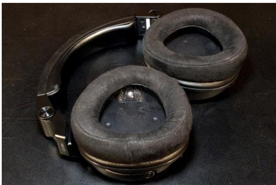
CZ-8A 耳罩內部。雖然較難辨認，但可以看到銀色螺釘下面有一個類似屏風的東西
