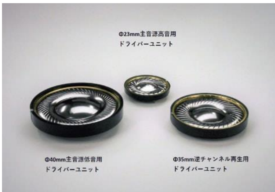
用於 CZ-8A 的揚聲驅動單元，振動膜全部有鍍塗層，主聲道的低音驅動單元為 40mm，與 CZ-1 相近
